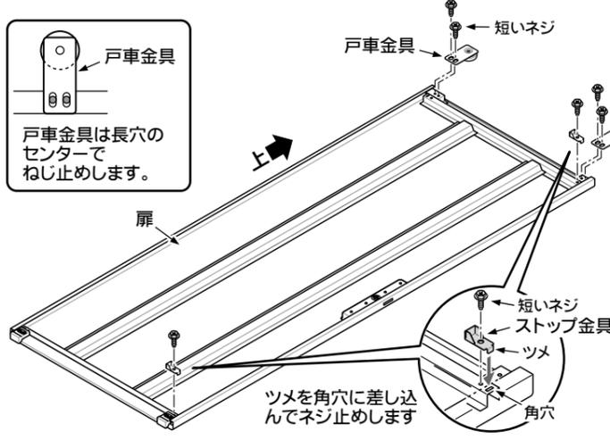
※【左引きの場合】は、扉下ガイドとすき間カバーをはずして、反対側へ付け替えてください。
