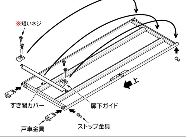
※上レールの角穴に戸車金具を差し込み、戸車を上レールに引っ掛けながら、扉下ガイドを下レールに入れてください。
