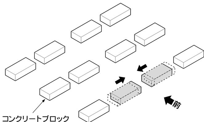
2. 基礎カバーを置き、その上に床枠を並べて物置本体を組み立ててください。
