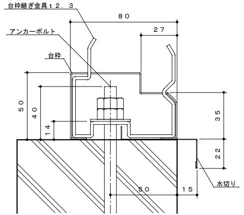
台枠、アンカー納まり詳細図 S=1 : 2
