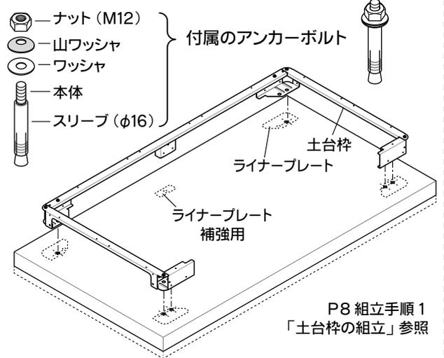
※土台枠を組み立ててからアンカー施工を行います。
