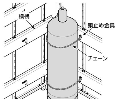
容器の転倒を防止するため、必ずチェーンを取り付けてください。容器が転倒・破損するとガス漏れなどの恐れがあります。
