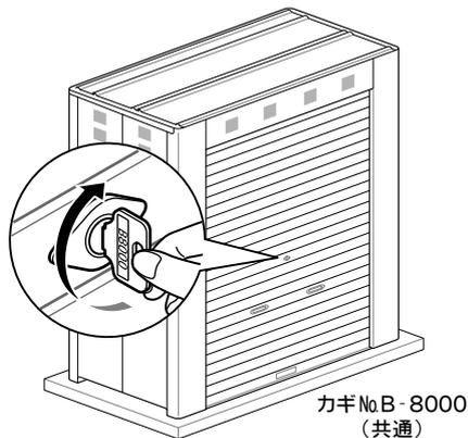
台風などの強風時は、シャッターが開いたり外れたりする可能性がありますので必ず施錠してください。庫内に強風が吹き込むと、破損・転倒する恐れがあります。
