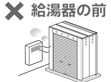
給湯器の前には設置しないでください。排気ガスが塗装を劣化させ、サビ・変色の原因となります。また、給湯器は火気とみなされる可能性があり、規則に抵触する恐れがあります。
