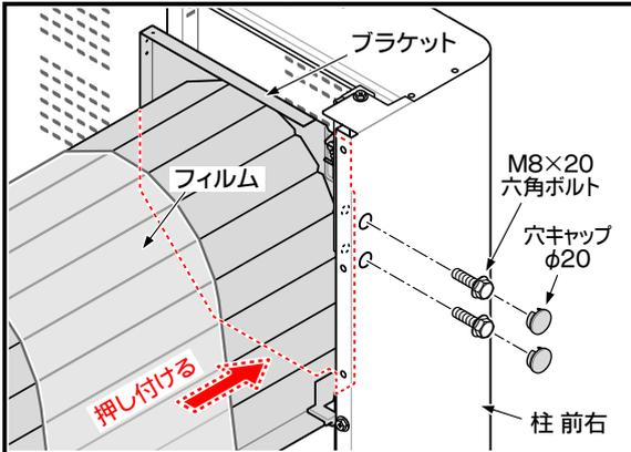
1. ブラケットの下部を、レール取付枠に押し付けながら、M8×20六角ボルトでネジ止めしてください。すき間があると、シャッターを正常に開閉できません。
