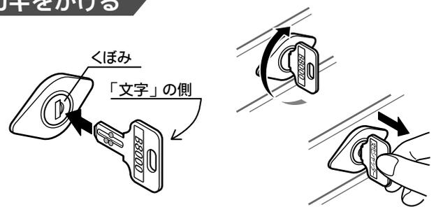
カギ穴のくぼみと、「文化シャッター」の文字の側を合わせてカギを差し込み、時計回りに半回転させます。施錠後は、必ずカギを抜いてください。
