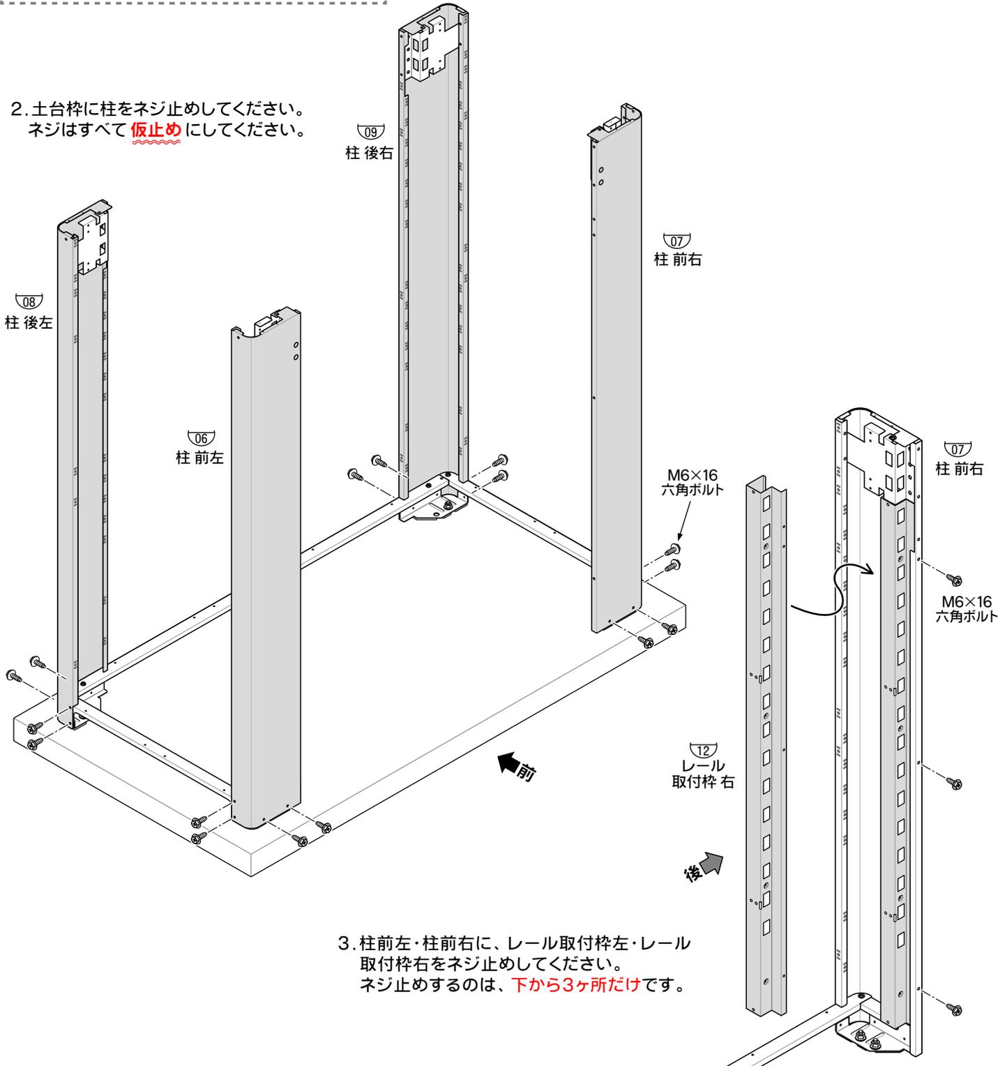
3. 柱前左・柱前右に、レール取付枠左・レール取付枠右をネジ止めしてください。
