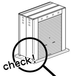
組立完了後、ボルトのゆるみや金具類の付け忘れがないか、確認してください。正しく組み立てられていないと、所定の強度が確保できなくなります。
