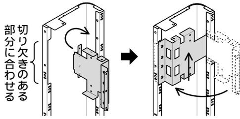
図のように、上補強材を柱の内側に引っ掛けて、切り欠きのある部分にはめ込み、上へ押し上げてネジ止めます。
