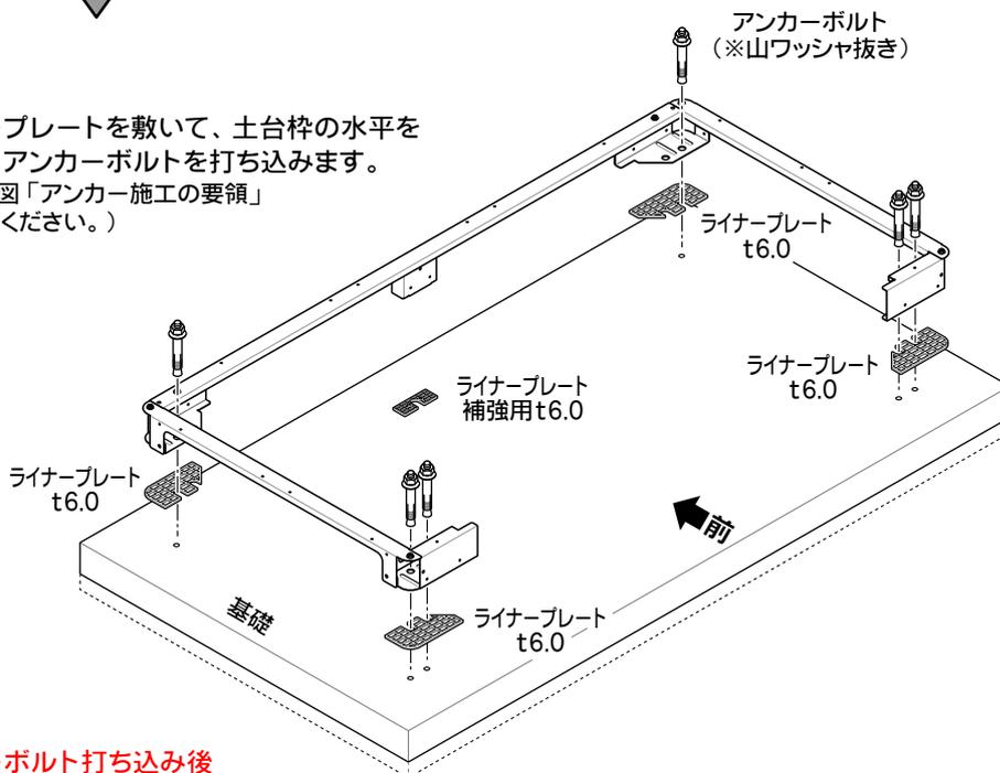
※ライナープレートは、ライナープレートt6.0:4枚と、ライナープレート補強用t6.0:1枚(1306・1310・1314型は無し)を必ず使用し、それ以外を水平調節用として使用します。
