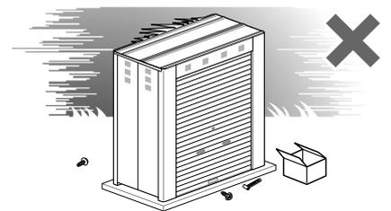
風の強い日は、施工を避けてください。部材が転倒して破損したり、飛ばされた部品でケガをする恐れもあります。
