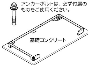
転倒予防のために、所定の基礎打設作業を必ず行ってください。台風などの強風時に転倒し、重大なケガや収納物に損害を与える恐れがあります。
