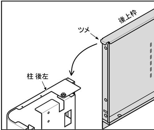
2. 後上枠の場合、いちばん下のネジ止めにはネジ板を使用します。
