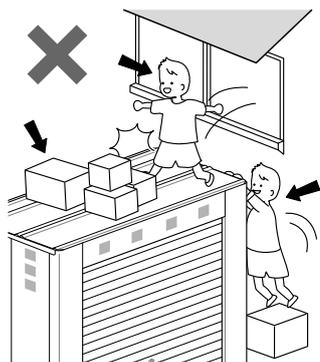
屋根の上に物をのせる・人がのる・ぶら下がる・他の建物から飛び乗るなどの行為はしないでください。転倒・落下などにより、ケガをしたり破損する恐れがあります。
