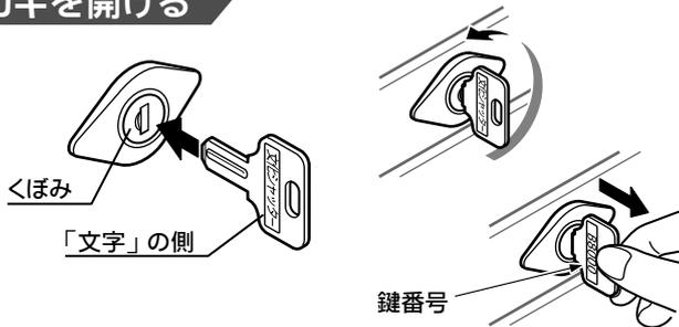
カギ穴のくぼみと、「文化シャッター」の文字の側を合わせてカギを差し込み、反時計回りに半回転させます。必ず、カギを抜いてからシャッターを開けてください。
