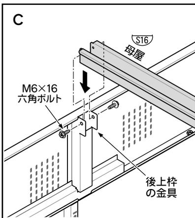
3. 前上枠と後上枠の金具に、母屋をネジ止めしてください。(C参照)
