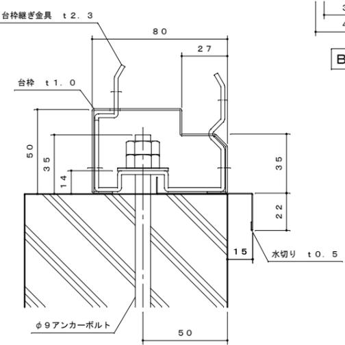
台枠、アンカー納まり詳細図 S=1:2
