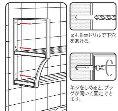
コンクリートドリルで穴をあけ、プラグを打ち込み、木ネジで固定します。
