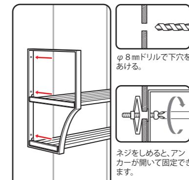
ドリルで下穴をあけ、アンカーを差し込み、ネジをしめると固定できます。
