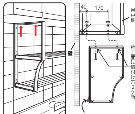
吊戸棚の底面に下穴をあけ、市販のボルト・ワッシャ・ナットで枠の上部を固定します。
