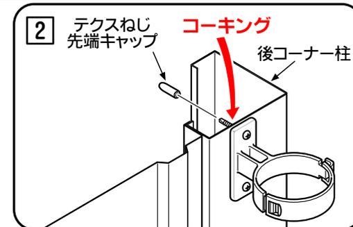
柱の内側から、テクスねじの根本をコーキングし、テクスねじ先端キャップをかぶせてください。(6ヶ所)
