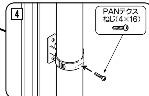
ずれ止めのため、センターの控具とたて樋をPANテクスねじで固定してください。(1ヶ所)
