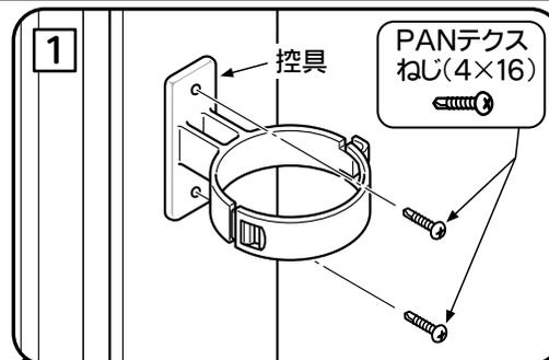
下図の位置に、控具をPANテクスねじで取り付けます。(3個:インパクトドライバー使用)
