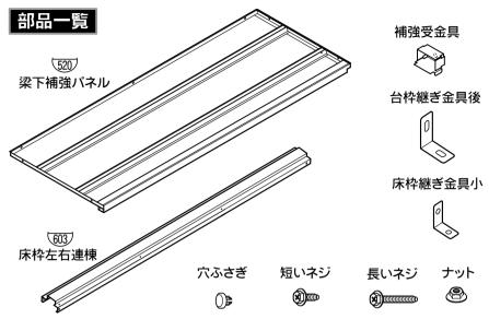
組立前に、部品が確実にそろっているか、図と部品明細で確認してください。
