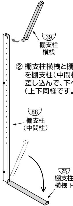
③ 棚支柱(中)を、短いネジ(M6)で取り付けてください。
