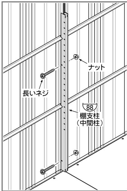
② 棚支柱横棧と棚支柱横棧下を棚支柱(中間柱)の角穴に差し込んで、下へ倒します。(上下同様です。)
