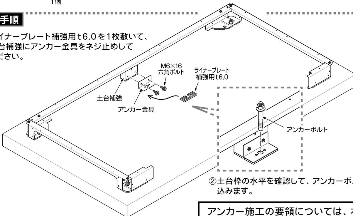
②土台枠の水平を確認して、アンカーボルトを打ち込みます。
